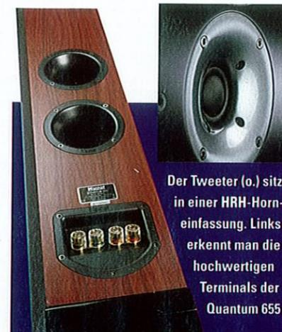
Der Tweeter (o.) sitzt in einer HRH-Horn-einfassung. Links erkennt man die hochwertigen Terminals der Quantum 655
